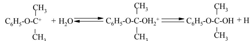
Под действием протона кислоты и воды протекает гидролиз и образуется фенол и ацетон:
